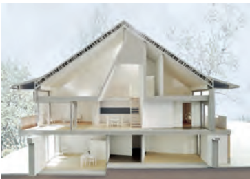
Querschnitt mit einem «Lichtkamin» ins Wohngeschoss
