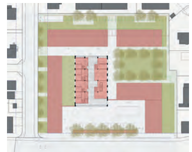
Studie zur Bebauung des Areals unter Erhalt der «Urhalle». Rot: mögliche Neubauten Links: denkbare Einbauten in der Halle
